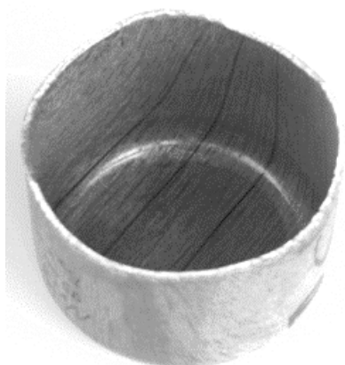
Рис. 7. Стакан, полученный способом глубокой вытяжки из исходно литой полосы сплава ENAW-6082
